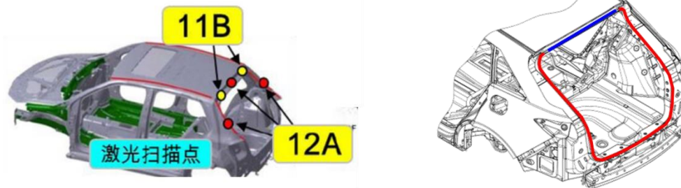
图4 3D激光引导定位系统定位示意图
