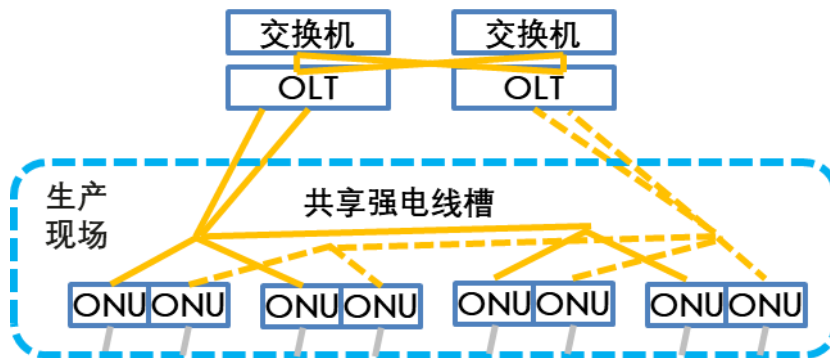
图 5 工业 PON 组网架构
