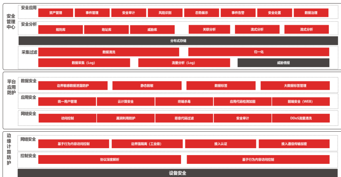
图 2 工业互联网平台综合防护体系框架
