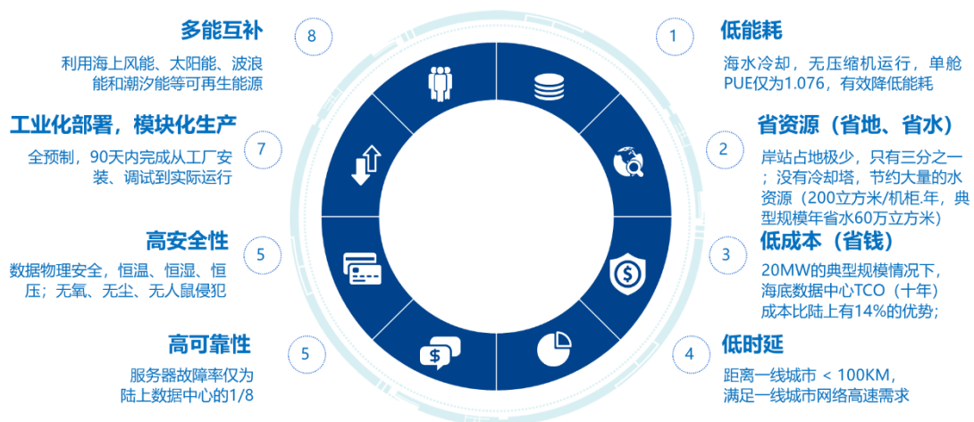
图 4 海底数据中心实施成效
