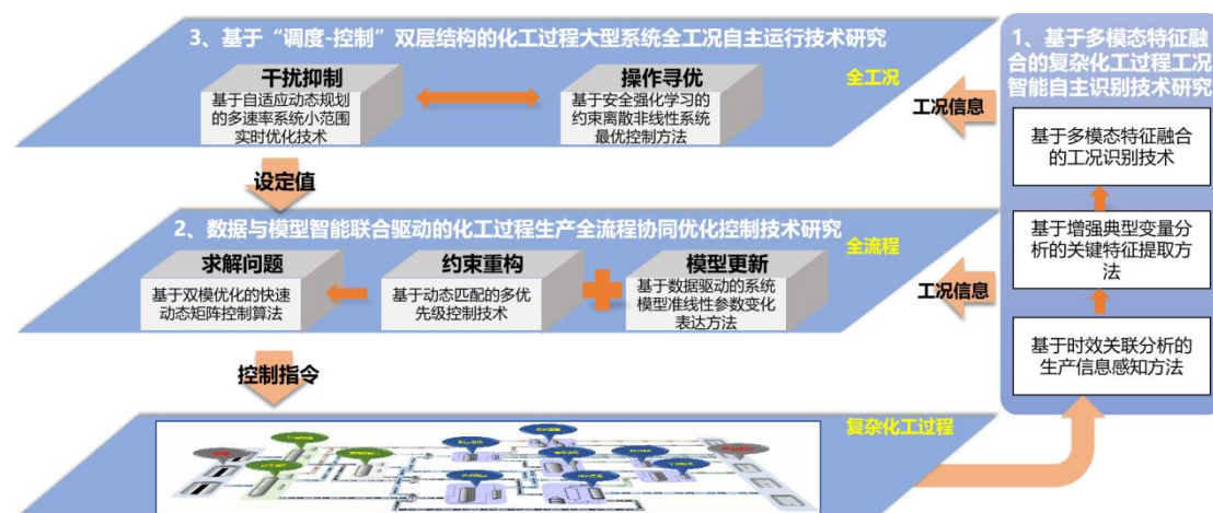
图 3.6 基于“调度-控制”双层结构的化工过程全工况“零手动”技术方案
