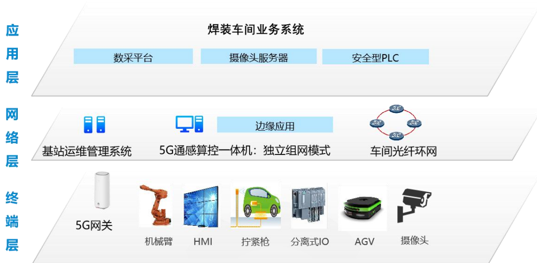
图 3.2 汽车制造焊装车间系统方案架构图
