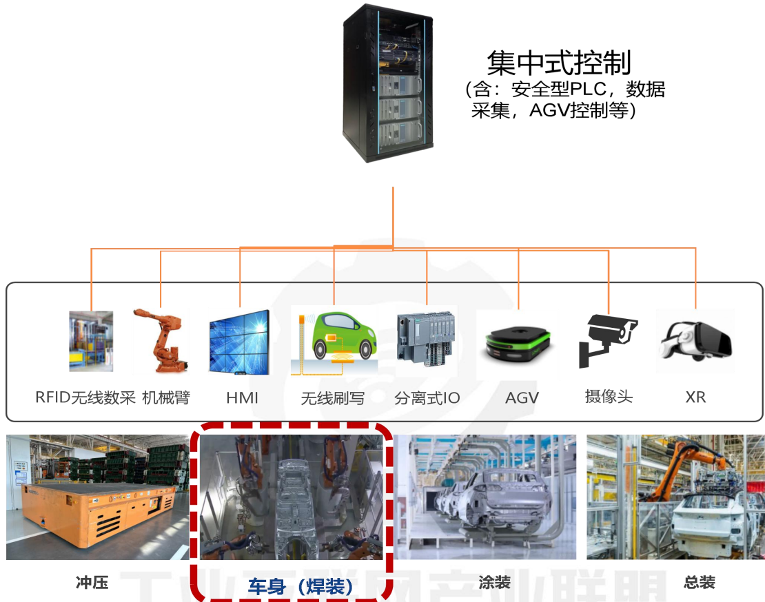
图 3.1 焊装车间产线集中式控制示意图
