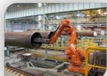
UOE焊管喷印标记
