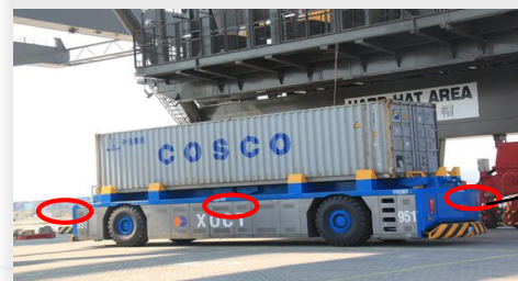
天线安装于AGV两侧
