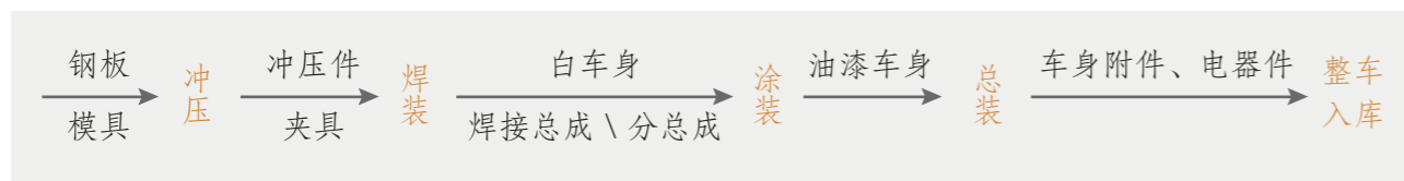
图 1-1 汽车量产阶段四大工艺
