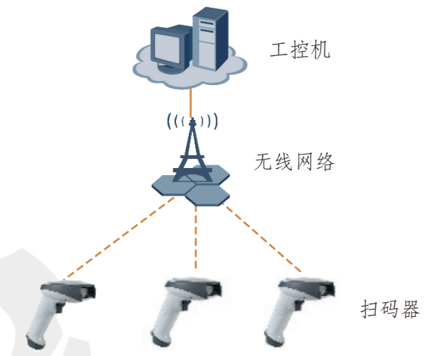
图 2-13 车辆装配过程中的无线扫码示意图
