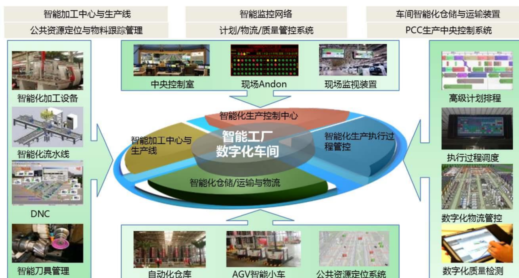
图 3.6 三一重工 18 号智能工厂实施架构
