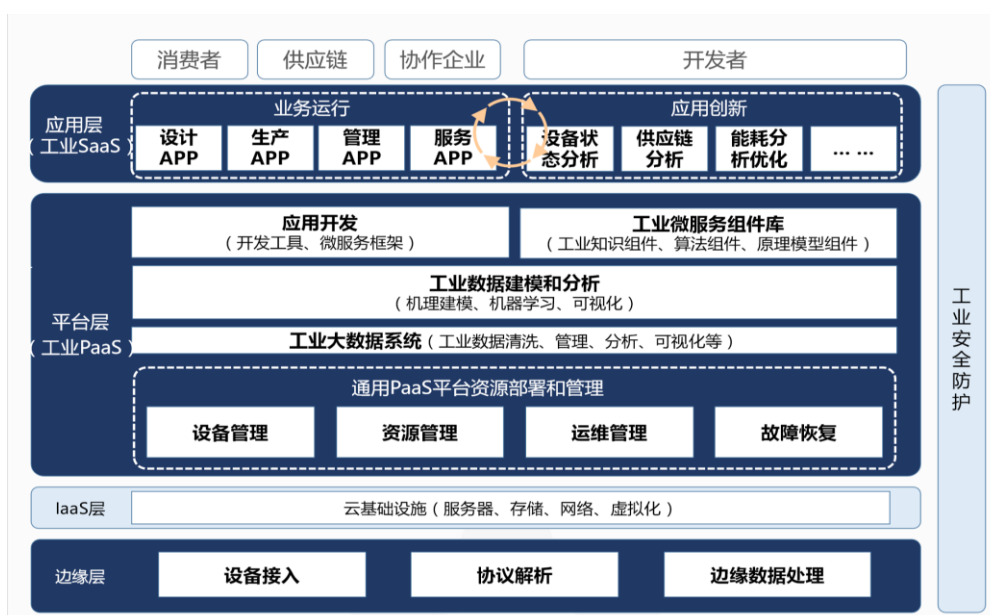
图 1-1 工业互联网平台功能架构
