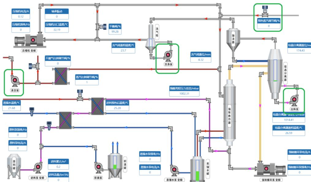
图 2 MVR 蒸发装备关键数据采集分布图
