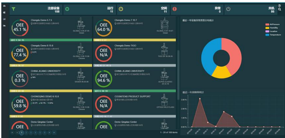
图 7 设备状态实时监控界面
