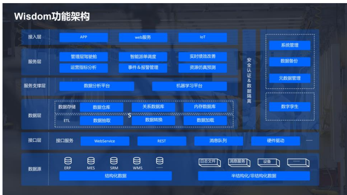
图 2 华清科盛工业互联网平台核心功能架构图
