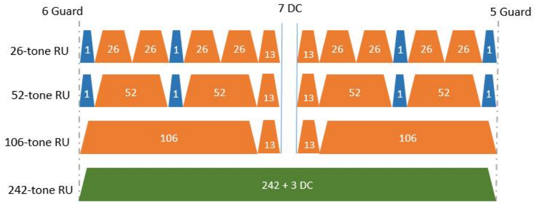
图表 3- 4 RU 在 20MHz 中的位置示意图
