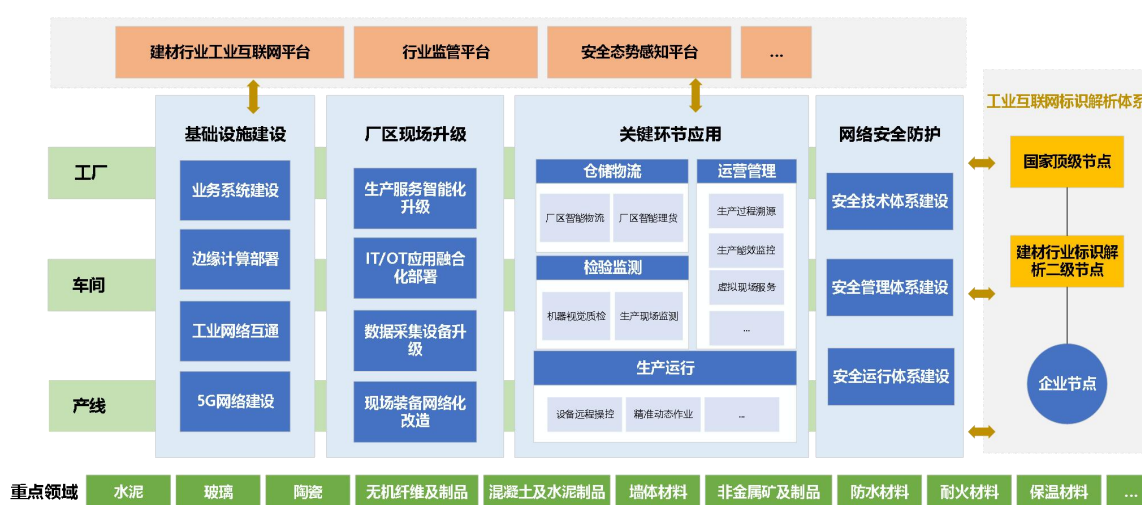
图 2 建材 5G 工厂架构图
